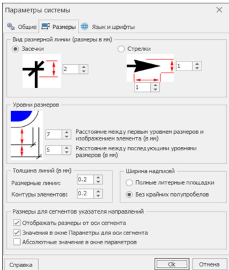
Если в группе настроек **Размеры** для сегментов указателя направлений установлен флажок **Отображать размеры от оси сегмента**, то размер будет отображаться согласно рис. 1, а если флажок не установлен, то согласно рис. 2.
