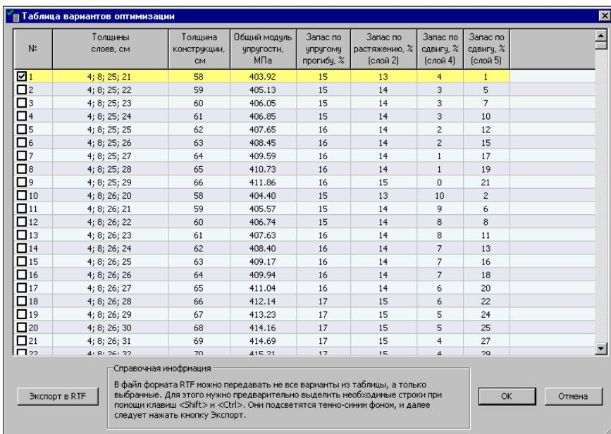
Окно диалога предлагает список вариантов оптимальных конструкций, которые удовлетворяют заданным критериям оптимизации. Оптимальная конструкция, выбранная системой, выделяется флажком и желтым фоном.
