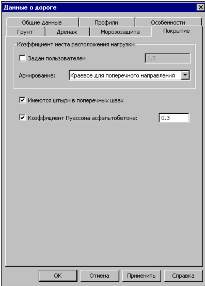
**Коэффициент места расположения нагрузки (Км)** учитывается при расчете растягивающих напряжений при изгибе плиты. Значение Км меняется в зависимости от выбора типа армирования из выпадающего списка параметра **Армирование**:
