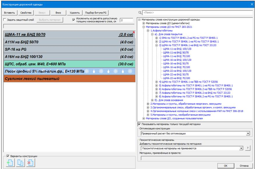
**Примечание** Группа материалов **Материалы слоев ДО (цементобетон)** предназначена для назначения материалов слоев цементобетонного покрытия или основания для конструкций дорожных одежд жесткого типа при новом строительстве.
